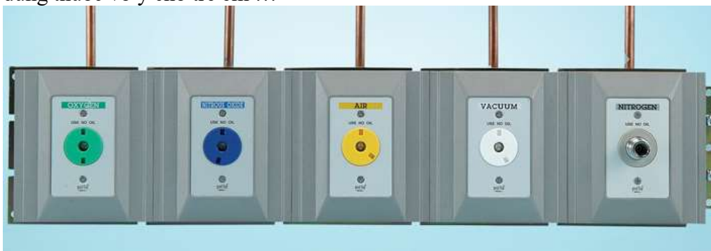
Hình 2.1: Hình hệ thống đầu ra của các loại khí nén và khí hút dùng trong y khoa. Chú ý vùng đầu cắm với các chốt khóa chuyên biệt. Điều này giúp tránh sử dụng sai đầu khí. Chỉ có giác cắm tương ứng mới có thể cắm vào được.
